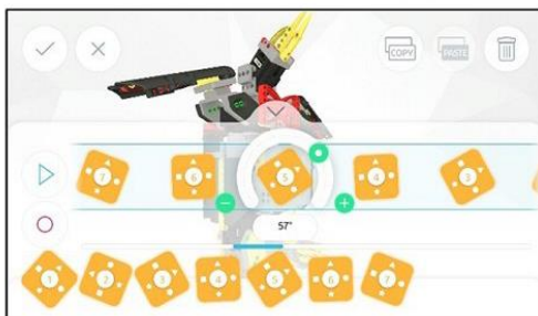
App中的“Rpp回讀功能” 讓使用者僅需扳動關節即可自動讀取 並輕鬆記錄動作，降低程式設計難度。
